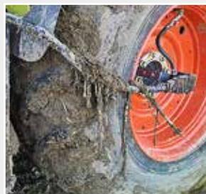
Zewnętrzne przewody nie są poprowadzone optymalnie.
