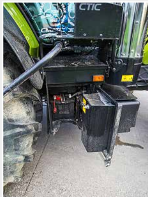
Goed toegankelijke overbruggingspool
