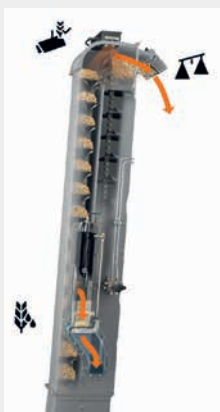
Lage der Sensoren im Körnerelevator
