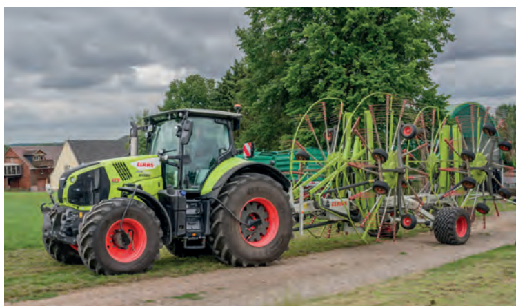
Das Ablassen der Luft vom Straßen- in den Feldbetrieb dauert nur ca. 30 Sekunden. Beim Schwaden schätzt Münster vor allem den verbesserten Fahrkomfort auf ausgetrockneten und harten Wiesenböden.
