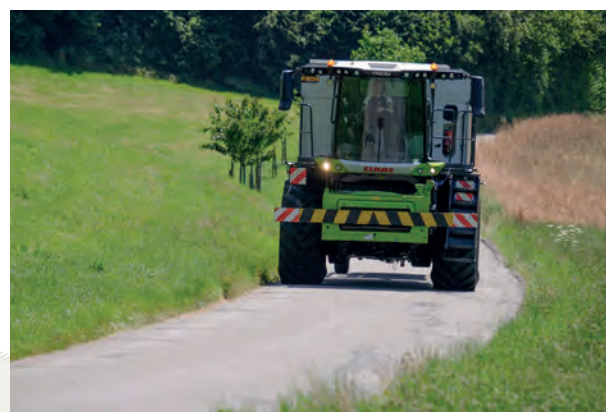
Die Zufahrten zu den Druschparzellen erfolgt meist über sehr schmale Straßen. Die maximal zulässige Außenbreite von 3,50 Meter hält der TRION 530 MONTANA auch mit 800er-Bereifung ein.
