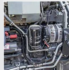
Il est impossible de remplacer proprement les filtres à huile montés debout.
