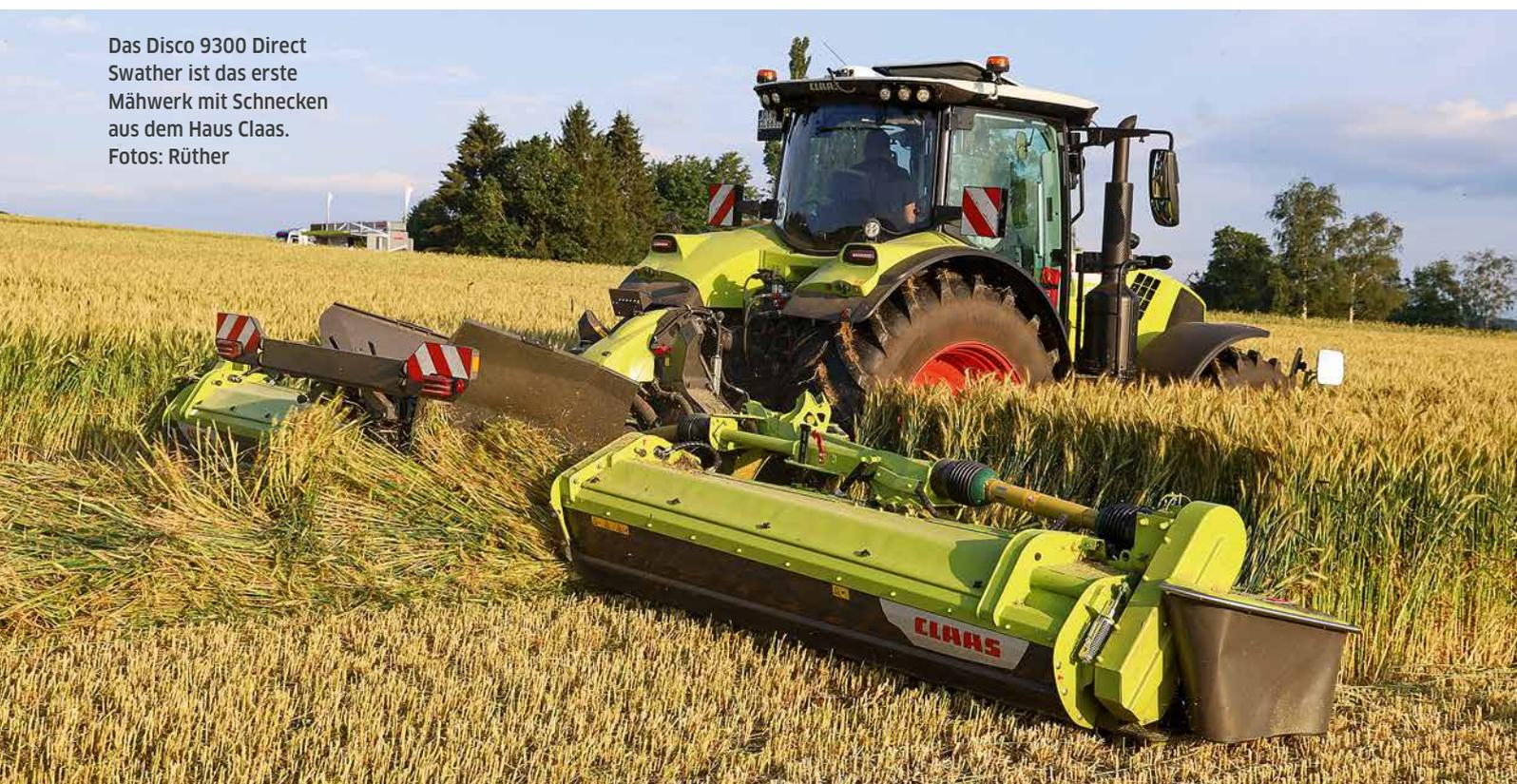
**B**ereits seit 25 Jahren hat Claas mit der Disco-Baureihe auch Großflächenmähwerke im Programm. Neu ist die Baureihe Direct Swather mit einer Schwadzusammenführung per Schnecke. Diese Mähwerke sollen vor allem eigenmechanisierte Landwirte mit kleineren Schleppern ansprechen. Schließlich ist die Maschine mit 3 t Eigengewicht etwa 400 kg leichter als ihr „großer Bruder“ mit Bändern. Hinzu kommt, dass der Schwerpunkt dank der kompakten Bauweise deutlich näher am Schlepper liegt.
