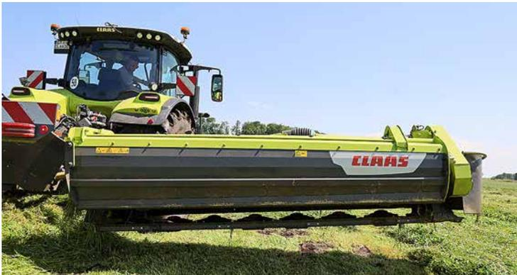
Bei Breitablage klappt die Schneckeneinheit nach oben und das Futter wird hinter dem Mähbalken abgelegt.
