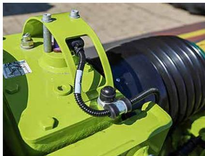
Drehzahlsensoren warnen den Fahrer bei Überlast.
