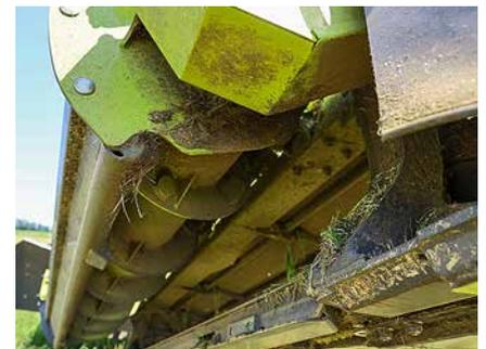
Die Schwadschnecken sind konisch geformt und werden per Riemen angetrieben.
