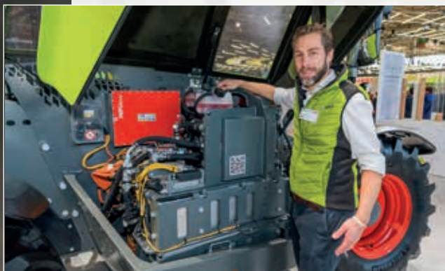
Die Batterieaufladung ist bei einer Ladeleistung von 22 kW innerhalb von drei Stunden möglich.
