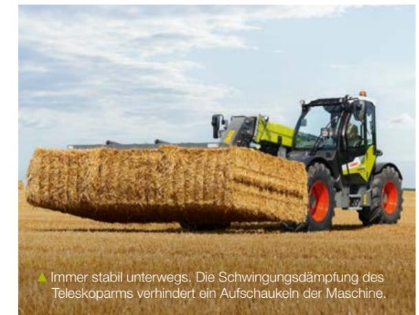
▲ Immer stabil unterwegs. Die Schwingungsdämpfung des Teleskoparms verhindert ein Aufschaukeln der Maschine.
