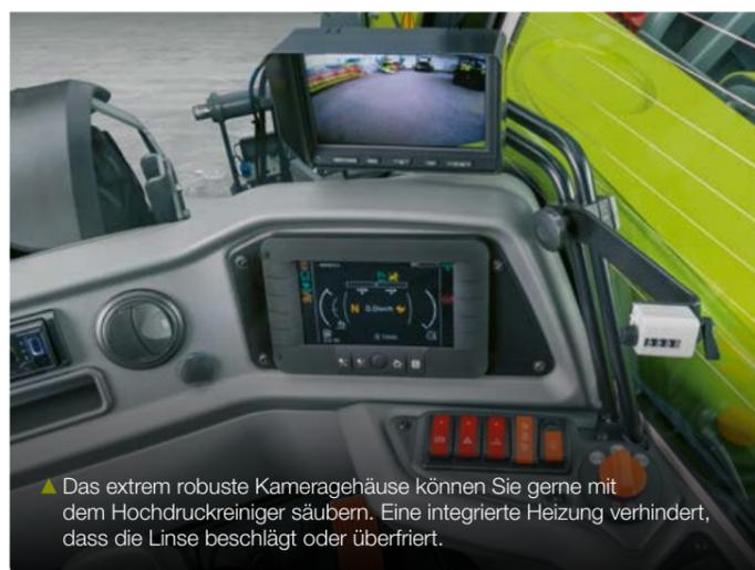
▲ Das extrem robuste Kameragehäuse können Sie gerne mit dem Hochdruckreiniger säubern. Eine integrierte Heizung verhindert, dass die Linse beschlägt oder überfriert.
