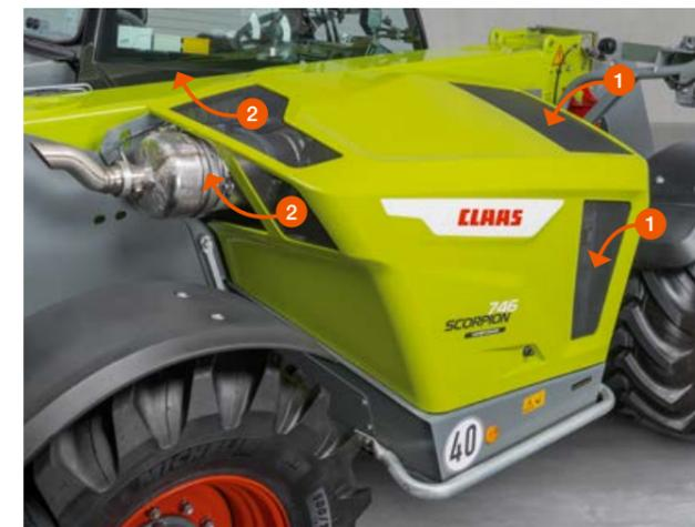
▲ Die Luft wird vorne im sauberen Bereich (1) angesaugt und am Heck (2) nach oben abgeführt. Das erschreckt die Tiere nicht und reduziert gleichzeitig die Staubentwicklung.
