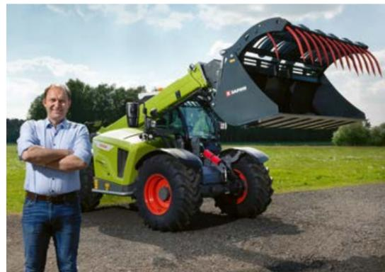
„Mit den VARIPOWER Systemen setzen wir auf sehr leistungsfähige hydrostatische Fahrantriebe. Sie stellen sicher, dass im gesamten Geschwindigkeitsspektrum von 0 bis 40 km/h auch bei hohen Lasten keine Verzögerungen spürbar sind.“
