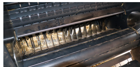
Die Messer ermöglichen das Schneiden des Ernteguts für Silage oder, mit nur wenigen Messern, die Erhöhung der Ballendichte bei Heuballen.
