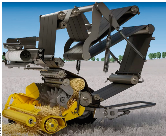
Eine variable Ballenpresse kann entweder eine hohe Ballendichte erzeugen, indem sie den Ballen von Anfang an zusammenpresst, oder sie kann einen weichen Kern erzeugen (Bild rechts).
