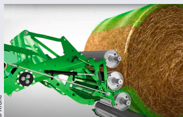
Ein Entenschnabel gleitet in die Presskammer und legt das Netz ab, das sich um den Ballen wickelt und seine Form nach dem Auswerfen des Ballens aus der Presse beibehält.
