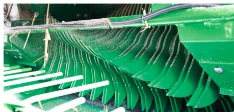
Der Zuführrotor besteht aus mehrzackigen Zinkensternen, die das Erntegut in die Presskammer befördern.
