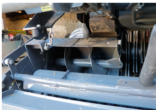
Um Ballen mit gleichmäßiger Dichte über die gesamte Breite zu erzeugen, ist die Presse mit zwei vom Rotor getrennten Zuführschnecken ausgestattet.
