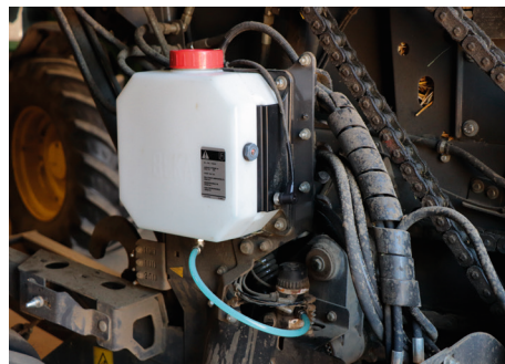
La lubrification des chaînes est automatisée de série, et le graissage centralisé pour les roulements de la chambre, de l'ameneur ou du pick-up.
