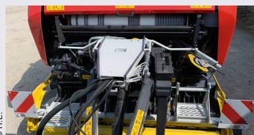
Das Bindesystem befindet sich an der Vorderseite der Presse, so dass es von der Traktorkabine aus sichtbar ist.
