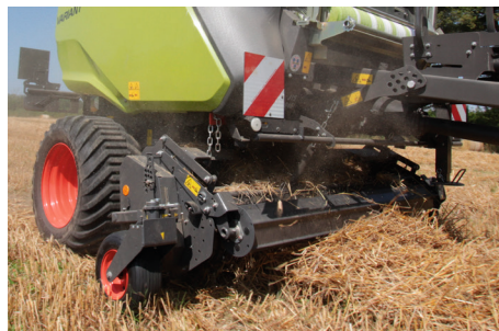
Die Claas Variant 585 RC verfügt über eine 2,15 m (nach DIN) breite, gesteuerte Pickup, die aus vier Zinkenträgern besteht.
