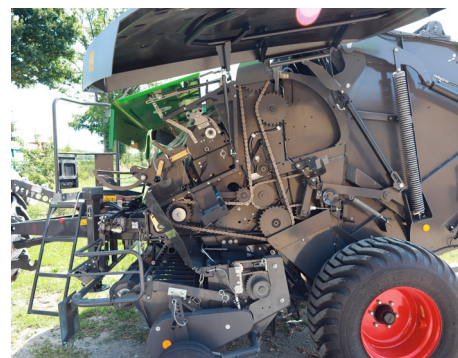
Der Antrieb einer Rundballenpresse erfolgt über einen Antriebsstrang mit Gelenkwelle, Winkelgetriebe, Rollenketten und Kettenrädern.
