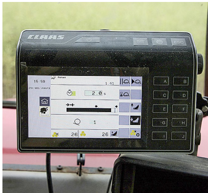
Bedient wird die Presse über das Cemis 700-Terminal mit 7 Zoll großem Touchdisplay.
