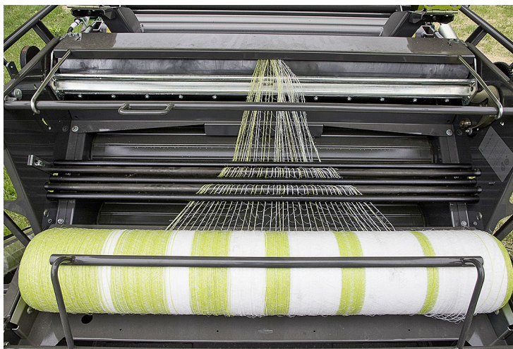
Die Netzbindung ist gut zugänglich und zuverlässig. Etwas fummelig ist das Durchführen durch die Netzbremse. Fotos: Bertling
