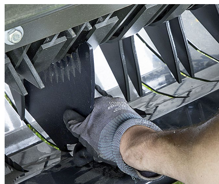
Etwas Übung braucht das Wechseln der Messer, die sich von hinten entnehmen lassen.
