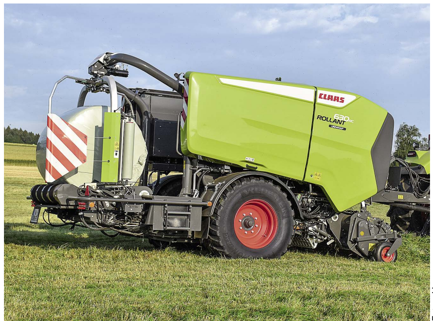
△ Der Ballendurchmesser lässt sich bei der Rollant 630 zwischen 1,25 und 1,35 m einstellen.
