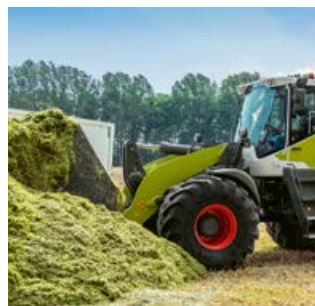
Reduzierte Auskippgeschwindigkeit schont die Komponenten am Hubgerüst.
