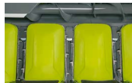
Die Pflückplatten lassen sich hydraulisch verstellen.
