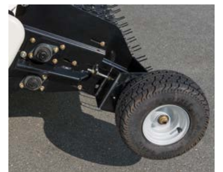
Die Arbeitstiefe ist über Tasträder einstellbar.
