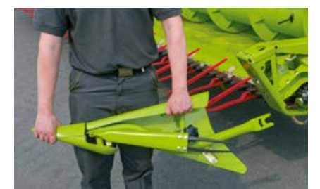
Die Halmteiler lassen sich schnell auswechseln.
