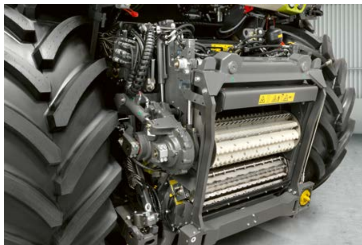
▲ La precompressione totalmente idraulica consente un'elevata produttività con ogni tipo di coltura e lunghezza di taglio, garantendo una qualità del trinciato costantemente omogenea. Pagina 22
