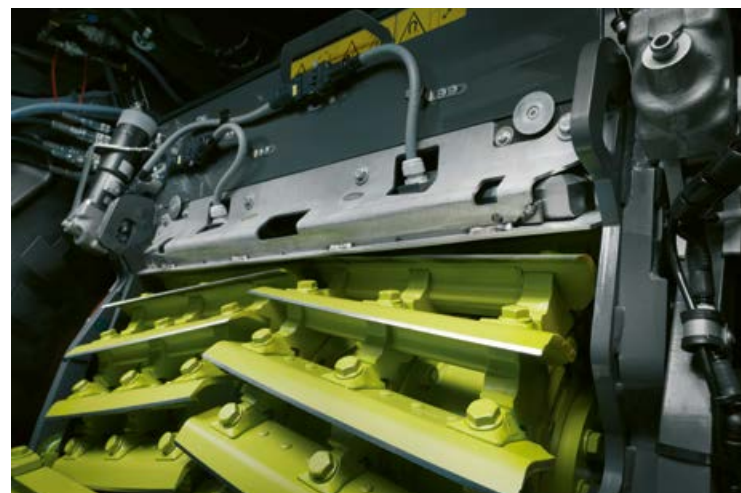
▲ NOVITÀ: CEMOS AUTO KNIFE CONDITION mantiene costantemente affilato il tamburo di trinciatura V-FLEX largo 910 mm, garantendo un taglio preciso e un flusso uniforme. Pagina 26
