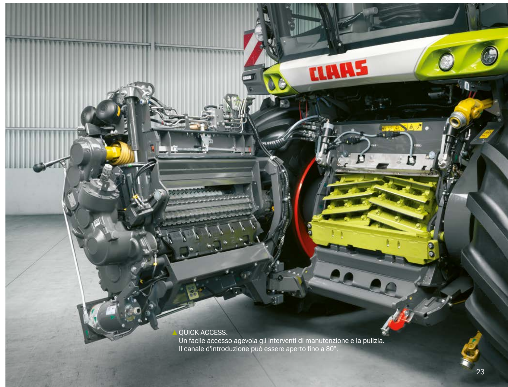
▲ Il telaio oscillante garantisce attivamente (idraulicamente) o passivamente (posizione flottante) una compensazione laterale regolata per adeguare la testata al suolo in modo ottimale.
