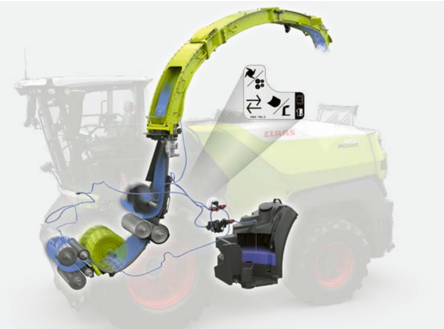
▼ Avec un ensilage de plantes saccharifères, l'ajout précis d'eau à certains endroits du flux de récolte comme la chambre d'alimentation, la tôle de transfert, l'accélérateur et la goulotte d'éjection assure un flux de récolte optimal.
