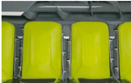
Plaques cueilleuses réglables par commande hydraulique
