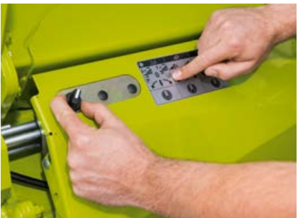
Commande de la position de stationnement et de nettoyage directement sur la barre de coupe
