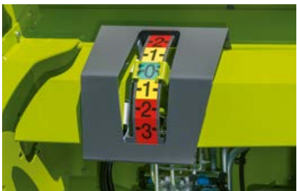
Position momentanée de la scie parfaitement lisible depuis la cabine
