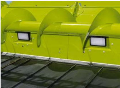
Potentes focos de trabajo iluminan de forma perfecta el mecanismo de corte y la cuba.
