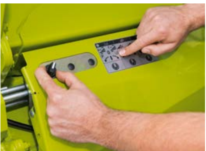
Ajuste de la posición de reposo y de limpieza directamente en el mecanismo de corte
