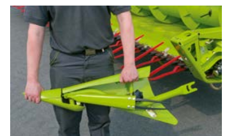
Los divisores de mies ofrecen un cambio rápido.
