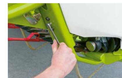
La altura del divisor de mies la gradúa fácilmente con la llave para las tapas
