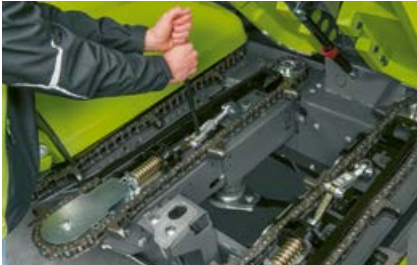
Las cadenas transportadoras puede retensarlas fácilmente.
