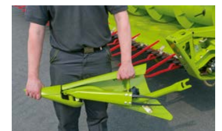
Los divisores de mies ofrecen un cambio rápido.
