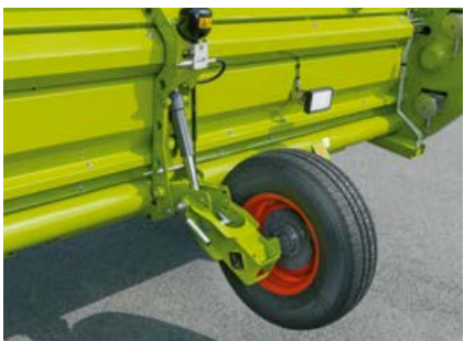
Dos robustas ruedas estabilizadoras para un mejor guiado por el suelo
