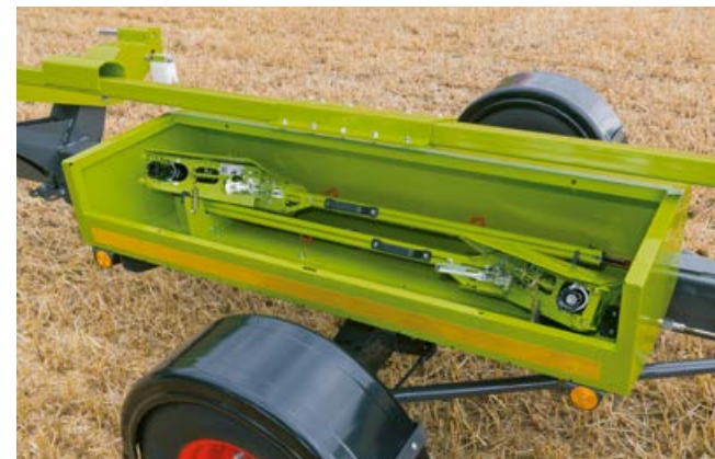
Para que usted pueda guardar de forma segura sus cuchillas separadoras de colza, todos los carros de transporte están equipados con una caja de transporte con cerradura.
