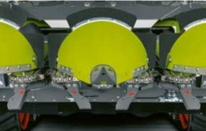
Gomas de recogida de mazorcas ofrecen una cosecha sin pérdidas.
