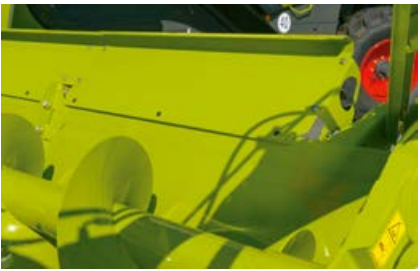
La elevación adicional de la pared trasera evita que se produzcan pérdidas por salpicaduras en colza.
