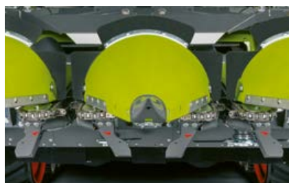
Kolbenfanggummis sorgen für eine verlustfreie Ernte.
