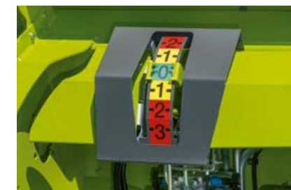
Die aktuelle Position des Messerbalkens ist von der Kabine aus gut sichtbar.
