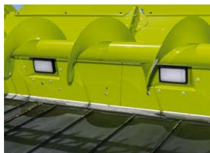
Starke Arbeitsscheinwerfer leuchten Schneidwerk und Trog perfekt aus.
