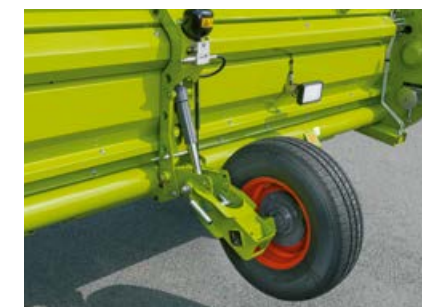
Zwei robuste Stabilisierungsräder für bessere Bodenführung
