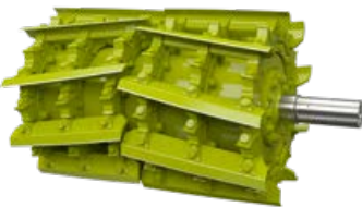
▲ Połowa noży zapewnia podwójną długość cięcia podczas pracy bez corncrackera.
