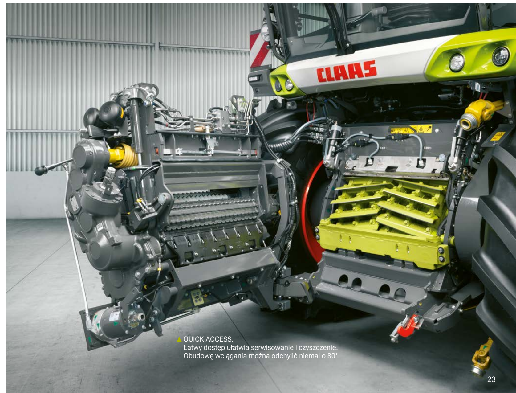
▲ Wahliwa rama zapewnia w sposób aktywny (hydraulicznie) lub pasywny (pozycja pływakowa) wyrównanie boczne, aby optymalnie dopasować przyrządy robocze do podłoża.
