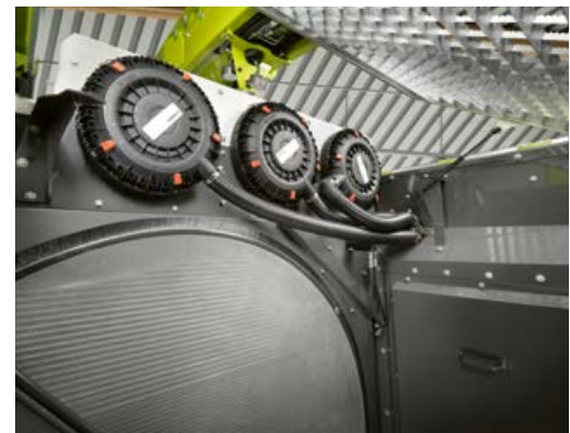
▲ Trzy filtry niezawodnie dostarczają powietrze do wydajnego silnika. W celu umożliwienia szybkiej konserwacji dostęp do nich jest możliwy bez użycia narzędzi.
