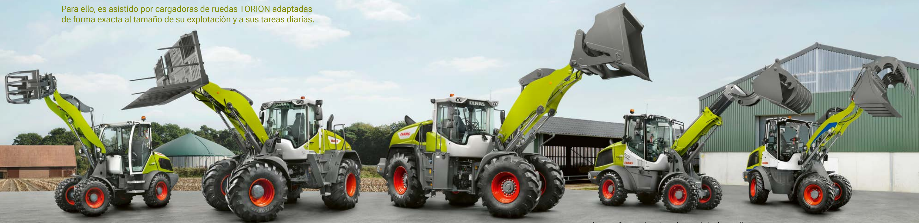
▲ La pequeña cargadora de ruedas para todos los que tienen grandes proyectos – especialmente en explotaciones con ganado vacuno y cultivos especiales. Sus punto fuerte son los trabajos de transporte en espacio muy reducido. La cinemática en z inclina ligeramente la horquilla al subir y se encarga de una sujeción segura del palé.
