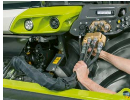
▲ Multikuppler erleichtern Ihnen den Anschluss.
