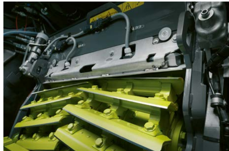
▲ NEU: CEMOS AUTO KNIFE CONDITION hält die 910 mm breite V-FLEX Messertrommel konstant scharf und sorgt so für präzisen Schnitt und gleichmäßigen Gutfluss. Seite 26
