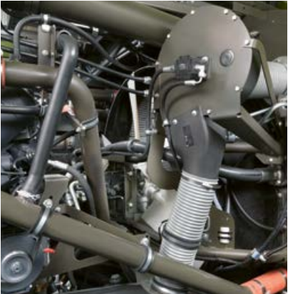
▼ En trabajos de campo y trayectos por carretera, el ventilador de aspiración está permanentemente activo.
