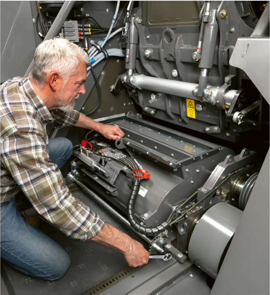
▲ Grandes tapas laterales hacen posible un acceso sencillo, por ejemplo, para el montaje y el desmontaje del corncracker o para limpiar sin herramientas los tres grandes filtros de aire.
