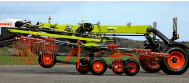
Effet jet des rotors lorsqu'on les relève ou les abaisse, semblable au comportement d'un avion au décollage et à l'atterrissage
