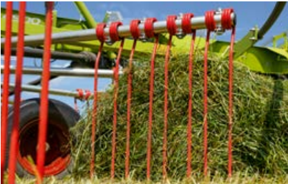
Dents renforcées pour un ratissage en douceur du fourrage
