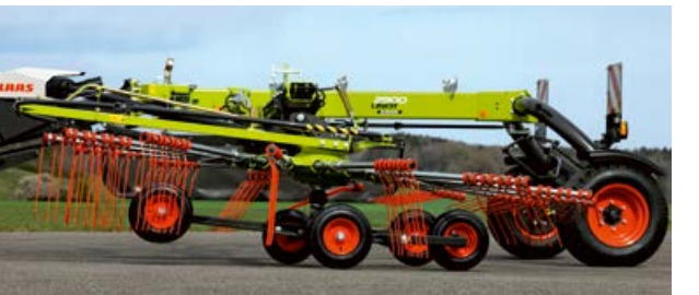
Ефект JET: під час підймання або опускання ротор поводить ся як літак під час зльоту або посадки.
