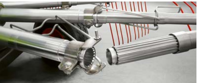
Зручний монтаж і демонтаж тримачів пальців: запатентована система фіксації граблин PROFIX зі шліцевим з'єднанням.
