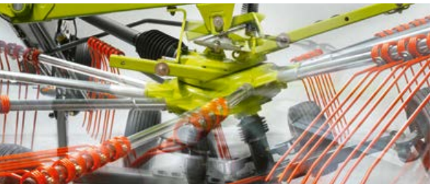
Кардана підвіска роторів: ротори пристосовуються до рельєфу поля — незалежно від трактора.
