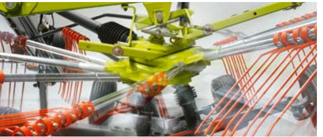
Enganche cardánico de los rotores: Los rotores se adaptan al suelo – independientemente del tractor.
