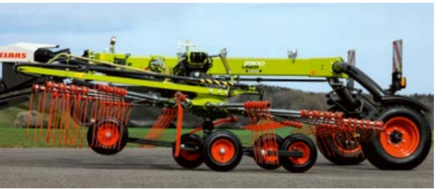
Effet jet des rotors lorsqu'on les relève ou les abaisse, semblable au comportement d'un avion au décollage et à l'atterrissage
