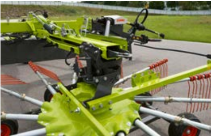
Réglage de la hauteur de travail. La hauteur de travail est réglable également par commande hydraulique (option), tandis que la sélection du côté est opérée par câble.
