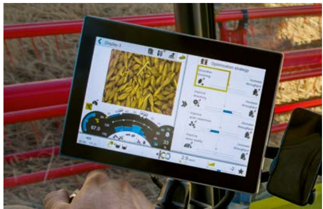
Comando intelligente tramite CEMOS AUTOMATIC tramite CEBIS
