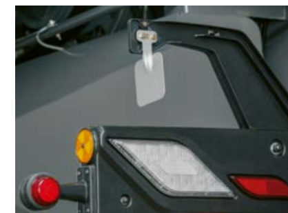
Sensore dell'adeguamento automatico della direzione di lancio.
