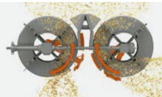
Éparpilleur radial pour un épandage de la paille efficace avec une consommation d'énergie minimale
