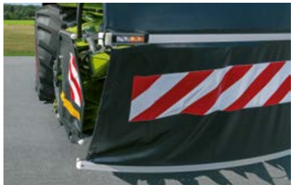
Les bâches latérales et avant sont bien visibles grâce aux autocollants d'avertissement. L'éclairage à LED est entièrement intégré.
