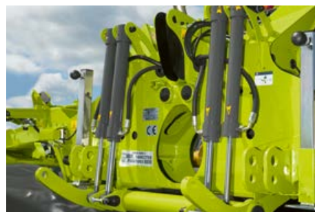
Die serienmäßigen Aushub- und Entlastungszylinder des ACTIVE FLOAT Entlastungssystems garantieren ein grasnarbenschonendes Ergebnis.
