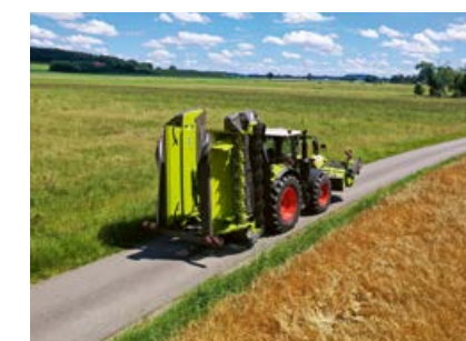
Kompakte Transportposition für sichere Straßenfahrten.
