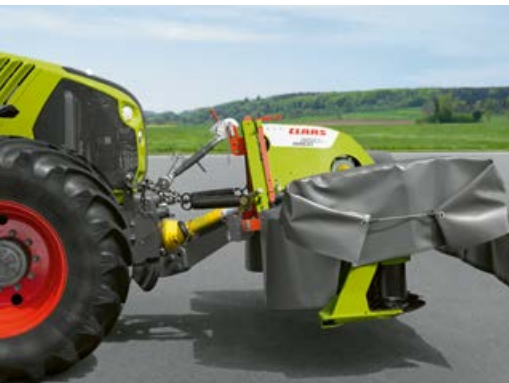
Selon la version, la faucheuse est dotée d'une suspension à ressort réglable ou de l'ACTIVE FLOAT.
