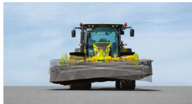
▲ La suspension à oscillation libre corrige les inégalités du sol sur l'axe transversal.
