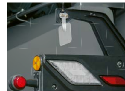
Sensor der automatischen Wurfrichtungsanpassung
