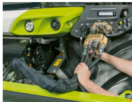
▲ Los acoplamientos múltiples le facilitan la conexión.
