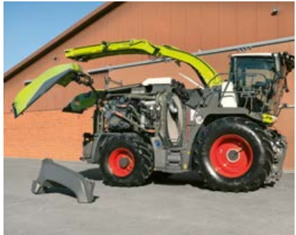
▲ Grandes tapas laterales hacen posible un acceso sencillo, por ejemplo, para el montaje y el desmontaje del corncacker o para limpiar sin herramientas los tres grandes filtros de aire.
