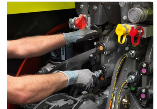
▲ Accouplement sans effort et sans erreur des flexibles hydrauliques. Tous les distributeurs hydrauliques à l'arrière du tracteur sont équipés de leviers de décompression, repérés par des couleurs et positionnés en quinconce afin de faciliter leur raccordement.
