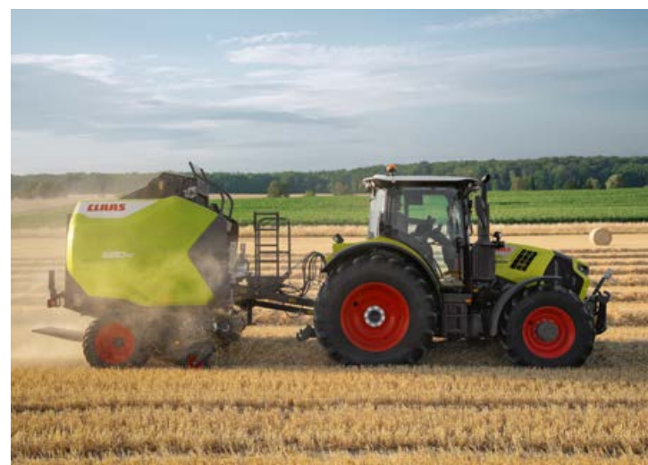
▲ Polyvalence maximale avec quatre régimes de prise de force. L'ARION Série 5 transmet toute sa puissance disponible à la prise de force, même à très faible vitesse.
