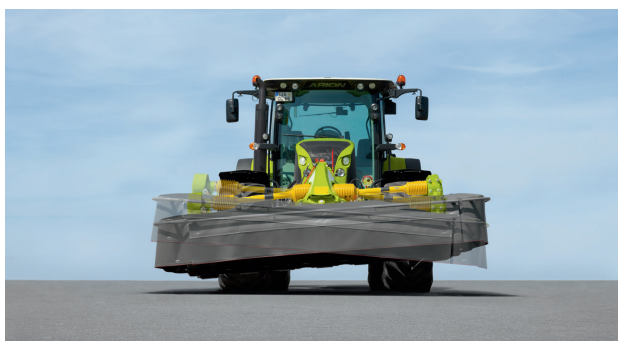
▲ Підвіс із вільним хитанням компенсує нерівності поперек напрямку руху.
