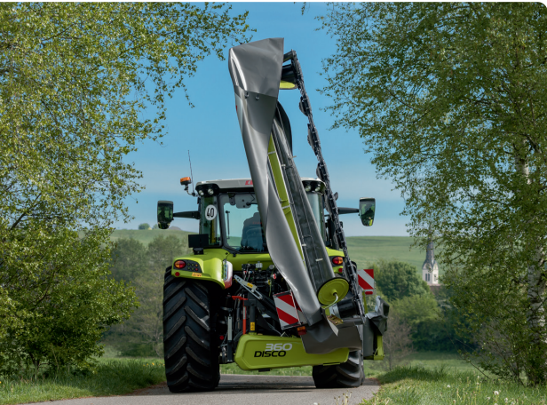
▲ Невелика транспортна ширина та вільний огляд ззаду: у транспортному положенні під кутом 105° із DISCO 100 можна безпечно рухатися автошляхами. ▼ Лінія дії сили проходить через центр ваги: розташована посередині розвантажувальна пружина робить переваги центрального підвісу доступними на задньонавісних косарках із боковим підвісом.
