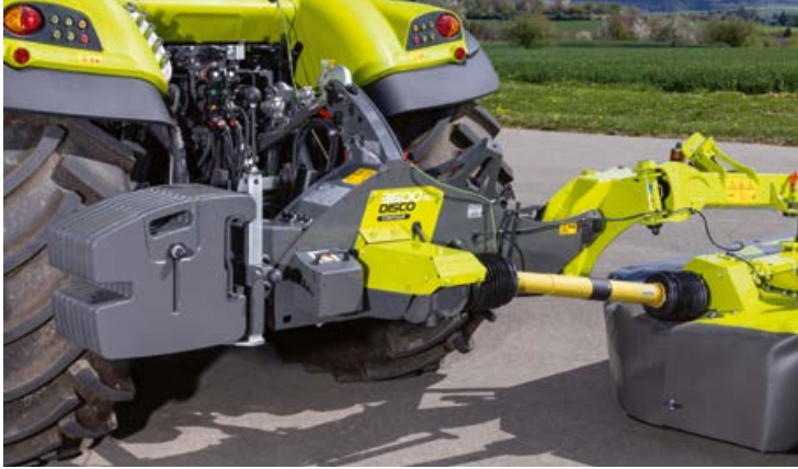
▼ Опційні противаги підвищують стійкість і рівень комфорту під час руху, а також дозволяють безпечно працювати на горбистій місцевості.
