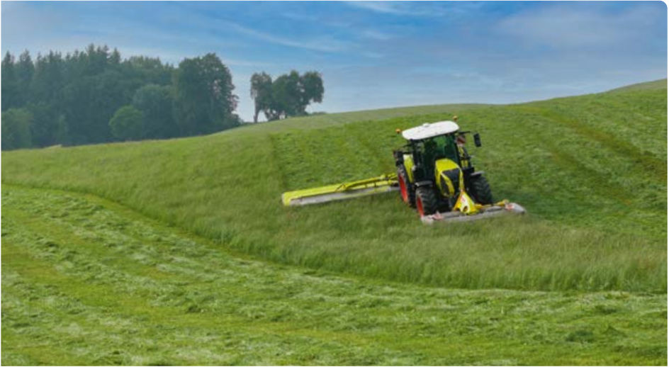
◀ Копіювання рельєфу навіть на схилах. Косарні модулі серії CONTOUR вільно хитаються й точно повторюють контури ґрунту.
