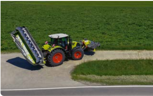
◀ Навіть найбільша косарка DISCO в транспортному положенні стає компактною, хоча її робоча ширина становить 4,20 м.
