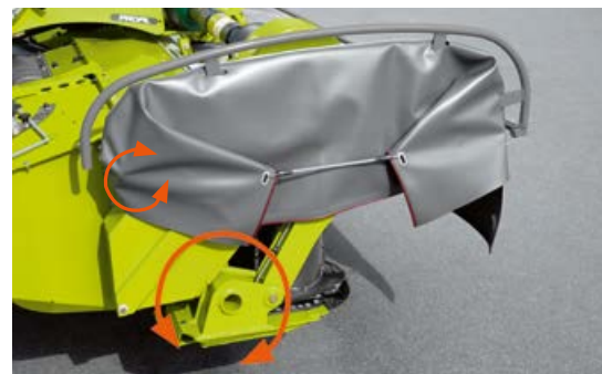
▲ Завдяки низькорозташованій точці обертання DISCO точно копіює рельєф ґрунту.
