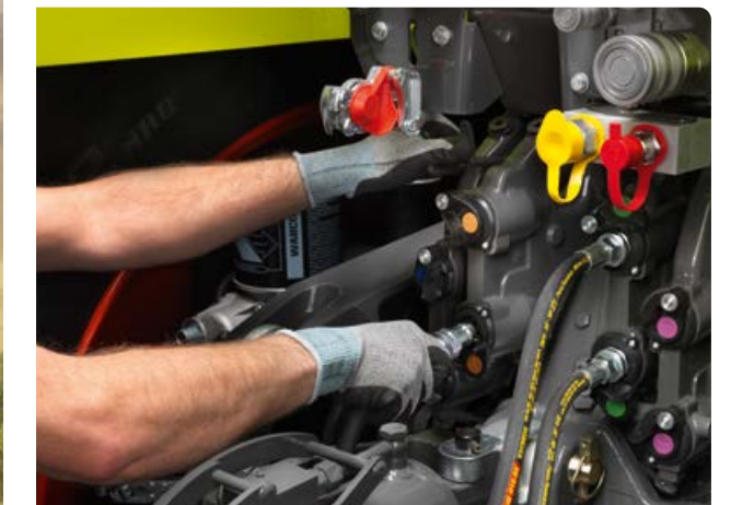
▲ Innesto senza pressione, pulito e senza errori. Tutti gli otto innesti idraulici nella parte posteriore sono dotati di leve di scarico e contrassegnati con colori diversi.
