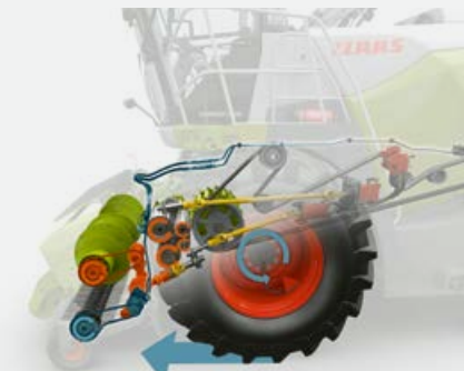
Accionamiento variable del cabezal
