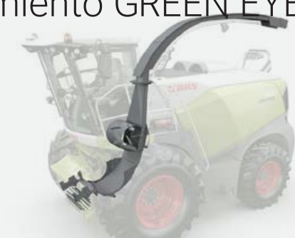
Flujo de material PREMIUM LINE con contracuchilla
