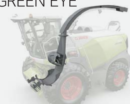
Flux de récolte PREMIUM LINE avec contre-couteau
