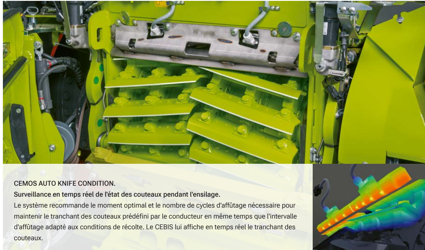
Détection de l'état des couteaux par induction magnétique
