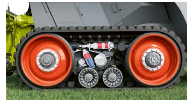
Powierzchnia przylegania 100%: rolka jezdna ma pełny kontakt z podłożem.
