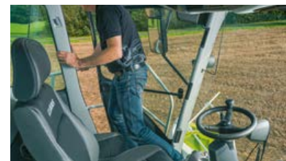
Wyłącznik w fotelu automatycznie wyłącza przyrząd roboczy i napęd główny.
