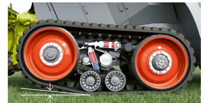
Powierzchnia przylegania 66%: rolka jezdna podnosi się podczas jazdy na zakrętach.
