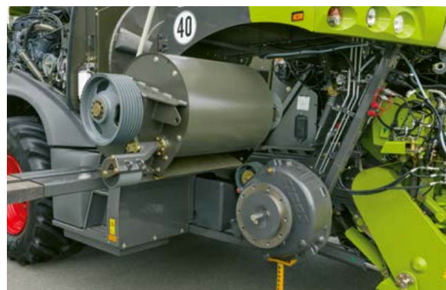
Łatwy montaż i demontaż przyspieszacza
