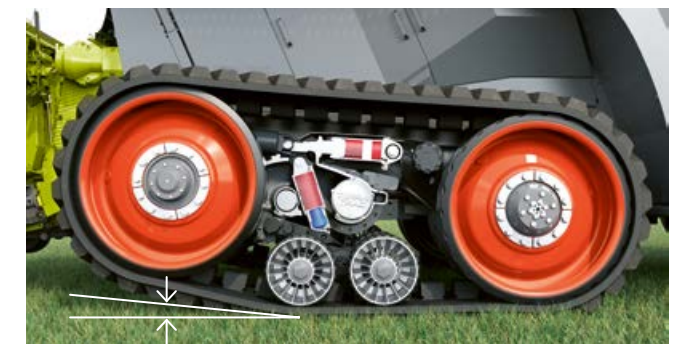
66% di superficie di appoggio: il rullo di scorrimento viene sollevato nei tratti in curva.
