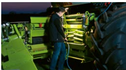
QUICK ACCESS consente di ispezionare gli organi di trinciatura in pochi minuti.
