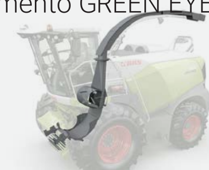
Flusso di prodotto PREMIUM LINE con controcoltello
