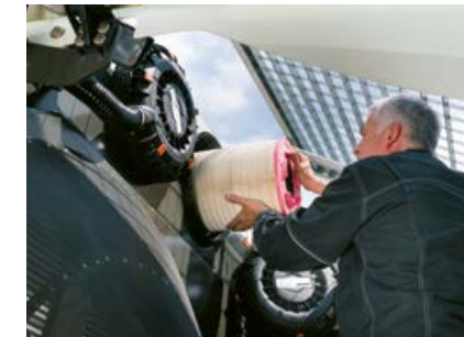
Cambio del filtro de aire sin herramientas
