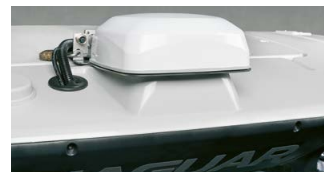
Antena SAT 900 i odbiornik w jednym – z zabezpieczeniem przed kradzieżą
