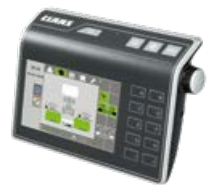
CEMIS 700. Terminale ergonomico, compatibile ISOBUS, con comandi touch, hardkey o encoder.
