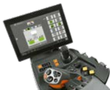
ISOBUS nel CEBIS. Comando della macchina direttamente tramite un terminale compatibile ISOBUS sul trattore.
