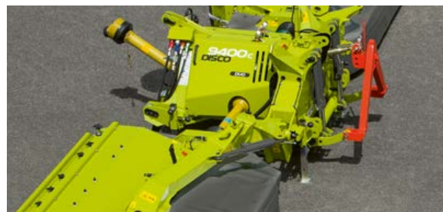
Защита гидрозамком двойного действия в случае столкновения: косилочная секция отклоняется и затем самостоятельно возвращается в исходное положение.
