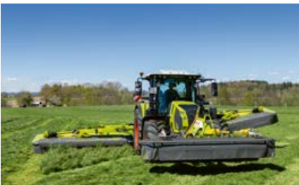
Компактная навеска обеспечивает большой дорожный просвет на разворотной полосе.
