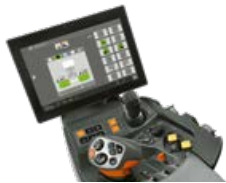
ISOBUS en CEBIS. Manejo de la máquina directamente con un terminal del tractor compatible con ISOBUS.
