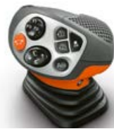
Palanca de marcha CMOTION. Manejo mediante teclas funcionales programables ISOBUS.
