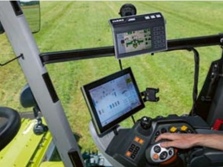
Manejo cómodo, por ejemplo a través de diferentes terminales ISOBUS y las teclas funcionales ISOBUS de la palanca de marcha.
