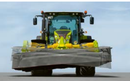
El enganche libremente pivotante compensa irregularidades transversalmente a la dirección de avance.
