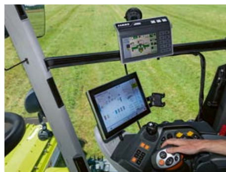
Komfortowa obsługa – na przykład przez różne terminale ISOBUS oraz przyciski funkcyjne drążka jeźdnego ISOBUS.
